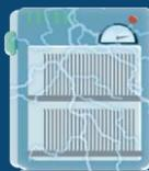
**3** モノマー気体はチャンバー内のすべての物に浸透して、基板表面と化学結合する。
